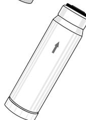
**3-я СТУПЕНЬ – «БАРЬЕР ПРОФИ Механика 1 мкм»** - фильтроэлемент из напыленного полипропилена пищевого класса. Последняя ступень предварительной фильтрации перед обратноосмотической мембраной: тонкая механическая очистка от мелкодисперсных взвесей с размером частиц более 1 мкм.
